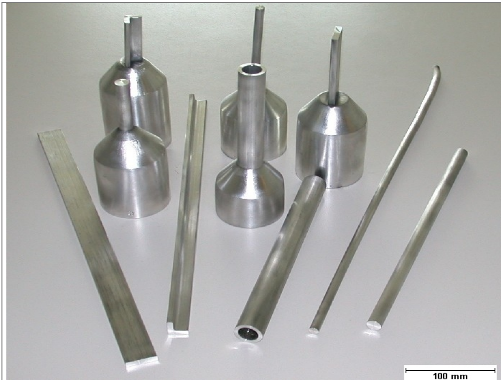
Abb.3.12: In Freiberg hergestellte Profilformen der aluminiumhaltigen Magnesiumlegierungen AZ31, AZ61 und AZ80.
