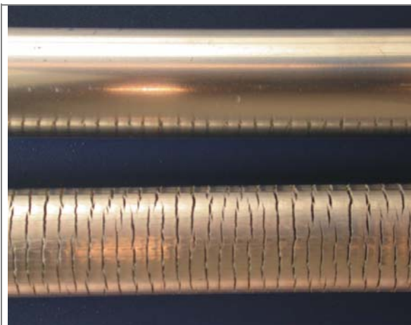
Abb.5.3a: Vergleich der Profiloberflächen der hydrostatisch (oben) und indirekt stranggepressten Profile (unten) aus der AZ80-Legierung /Swi03/.
