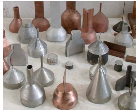
Abb.2.6a: Pressreste von stranggepressten Produkten aus Kupfer-, Aluminium-, Tantal- und Nioblegierungen der Firma CEP in Freiberg /Moe04/.
