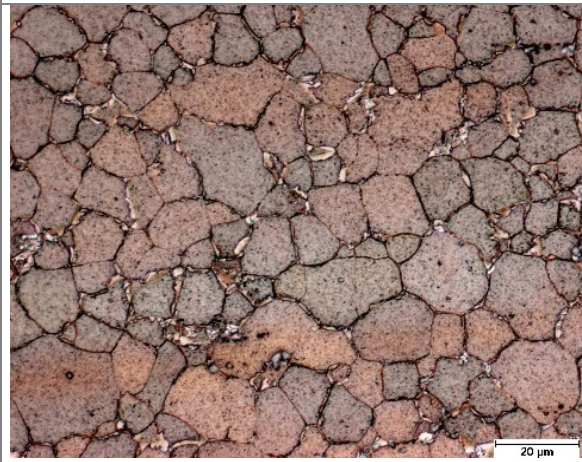
Abb.5.6f: Legierung AZ80, indirekt stranggepresst, T_S=300^\circ\text{C} , \psi=31.2 , v=3\text{m/min} , mittlere Korngröße 12\mu\text{m} (Strangpressrichtung \rightarrow ).
