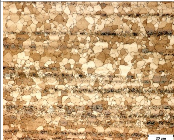
Abb.4.111: Gefüge von feinkörnigem (hydrostatisch stranggepresst), wärmebehandeltem AZ61.
