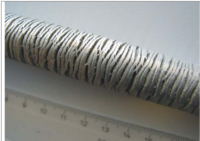
Abb.2.13: Heißrisse auf der Oberfläche des Mg-Profiles /Vir04/.
