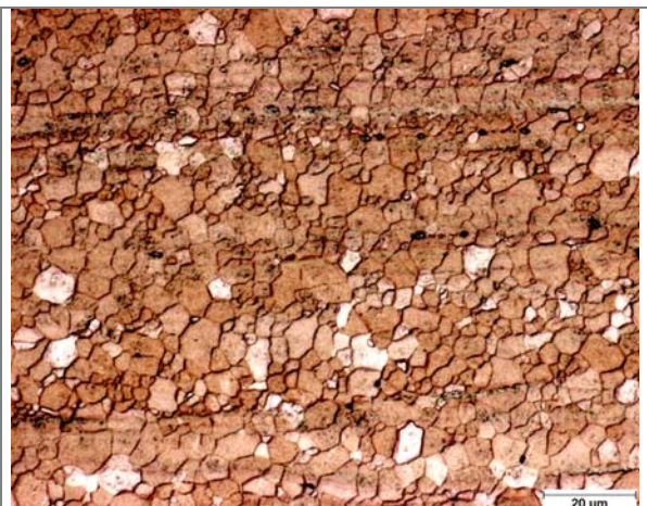
Abb.4.102: Legierung AZ61, Rechteckprofil 7.5x30mm, T_S=100^\circ\text{C} , \psi=24.6 , v=4.4\text{m/min} , mittlere Korngröße 4\mu\text{m} (Strangpressrichtung \rightarrow ).
