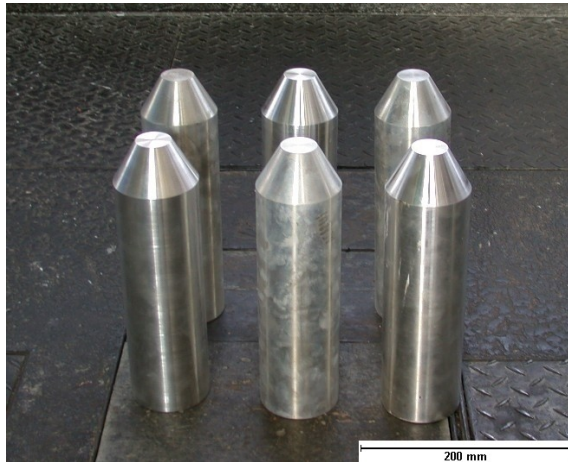
Abb.3.8: Abgedrehte Pressbolzen kurz vor dem Strangpressen.
