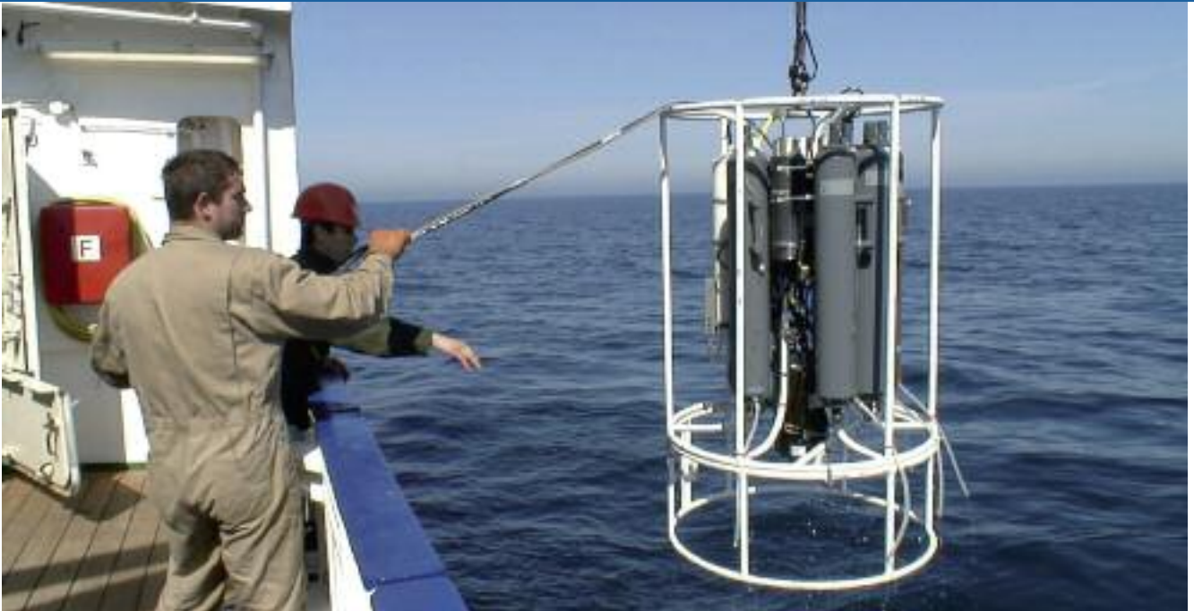
SONDENSYSTEM ZUR MESSUNG VON STREU- UND ABSORPTIONSKOEFFIZIENTEN SOWIE WEITERER EIGENSCHAFTEN DES MEERWASSERS. DIESE MESSUNGEN WERDEN ZUR AUSWERTUNG UND ÜBERPRÜFUNG DER MERIS-DATEN VERWENDET. SENSORSYSTEM FOR MEASURING SCATTERING- AND ABSORPTION COEFFICIENTS AND FURTHER PROPERTIES OF SEAWATER. THESE MEASUREMENTS ARE USED FOR THE EVALUATION AND VALIDATION OF MERIS DATA.
