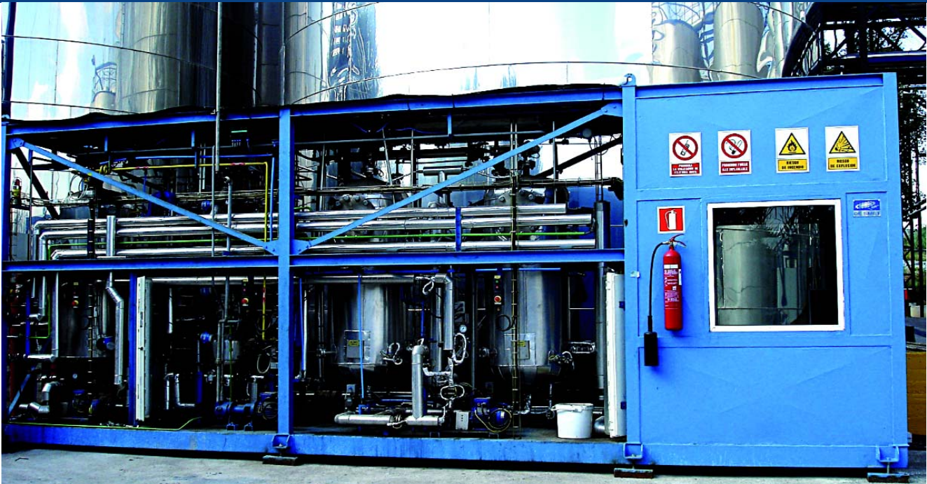
PILOTANLAGE ZUR HYDRIERUNG VON PFLANZENÖL IM MEMBRANREAKTOR (PLANUNG UND AUSFÜHRUNG: FA. DESMET ESPANA, MADRID; STANDORT UND BETREIBER: FA. LIPIDOS SANTIGA S.A. BARCELONA). PILOT FACILITY FOR THE HYDROGENATION OF VEGETABLE OIL IN THE MEMBRANE REACTOR (PLANNING AND IMPLEMENTATION: DESMET ESPANA, MADRID; LOCATION AND OPERATING COMPANY: LIPIDOS SANTIGA S.A., BARCELONA).
